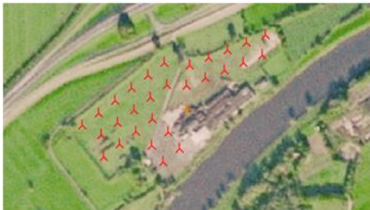
Afbeelding 2.5 Mogelijke opstelling kleine windturbines
