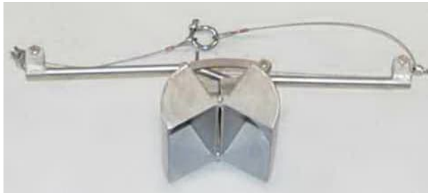
Figuur 4.3 Een Van Veenhapper voor het nemen van waterbodemmonsters en gebruik Van Veenhapper vanaf de boot
