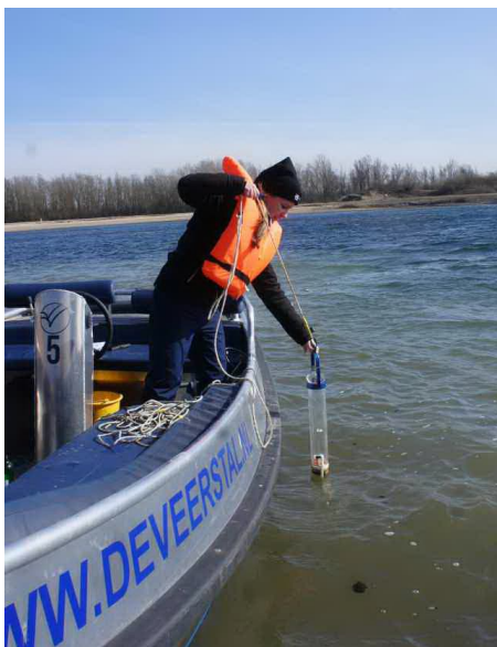
Figuur 4.4 Gebruik Ruttner fles om water op diepte te bemonsteren
