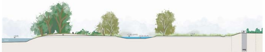
Dwarsprofiel A-A' door de uiterwaard. Links de oeverwal waar ingezet wordt op ontwikkeling van stroomdalgraslanden en oelbossen. In het midden het middelste geulsegment met opgaande beplanting in de oeverzone.
