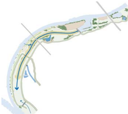
Schema variant 'éénzijdig aangetakte geul'
